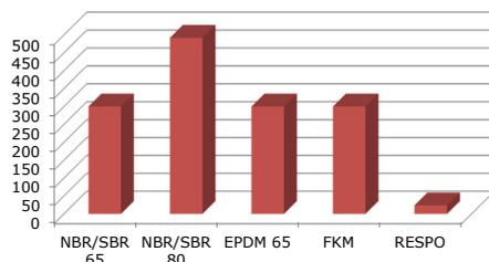
Druckverformungsrest 70 °C / 200 h
