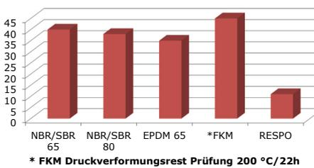
\* FKM Druckverformungsrest Prüfung 200 °C/22h
