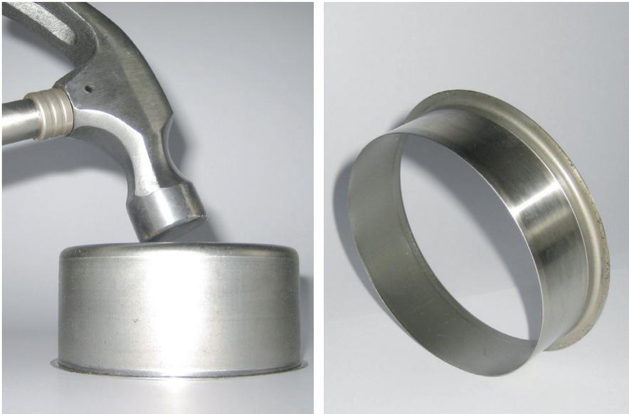
Reicht die Länge der Montagebüchse nicht aus, kann ersatzweise auch ein passendes Rohrstück verwendet werden. Muss der Bund der Hülse aus Platzgründen entfernt werden, kann dies leicht mit einem Seitenschneider entlang der „Sollreißstelle“ geschehen. Nach der Montage sollte die Welle nochmals auf Grate untersucht werden. Die Oberfläche wird leicht gefettet, abschließend erfolgt die Dichtungs- und Lagermontage.
